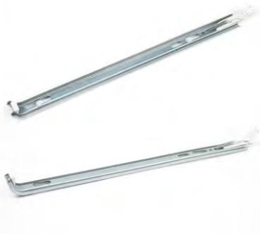
Кронштейн YК применяется для настенного монтажа стальных панельных радиаторов LEMAX Premium с универсальными элементами крепления типов 21 С (VC), 22 С (VC), 33 С (VC). Также их можно использовать и для радиаторов с приваренными элементами крепления. Высота кронштейна определяется высотой монтируемого радиатора. Изготавливается из оцинкованного листа ГОСТ 14918-80 толщиной 1,5 мм, конструктивный элемент,держивающий верхнюю часть радиатора,выкрашен белой краской EcoPolifix RAL 9016.
