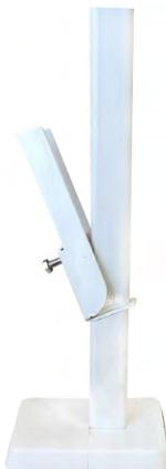
Напольный кронштейн К11.31 предназначен для крепления стальных панельных радиаторов LEMAX Premium с боковым и нижним подключением высотой 200-600 мм типов 11C (VC), 21 C (VC), 22 C (VC), 33 C (VC). Рекомендуем применять два кронштейна при установке радиаторов длиной от 400 до 1600 мм, три кронштейна – при длине от 1700 до 3000 мм.
