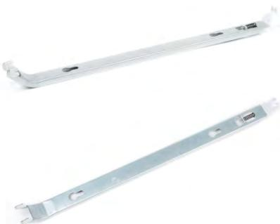
Кронштейн K15.3 применяется для настенного монтажа стальных панельных радиаторов LEMAX Premium с универсальными элементами крепления типов 21 С (VC), 22 С (VC), 33 С (VC). В тоже время их можно использовать и для радиаторов с приваренными элементами крепления. Высота кронштейна определяется высотой монтируемого радиатора. Изготавливается из оцинкованного листа ГОСТ 14918-80 толщиной 1,5 мм, конструктивный элемент,держивающий верхнюю часть радиатора,выкрашен белой краской EcoPolifix RAL 9016.
