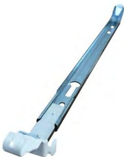
Настенные кронштейны для панельных радиаторов LEMAX Premium с универсальными элементами крепления высотой 500 мм типов 21 VC, 22 VC, 33 VC. Мультирегулируемая верхняя часть, каждый кронштейн выдерживает до 150 кг. Если радиатор монтируется с помощью настенных кронштейнов F7V EASY, то установка соответствует классу 3 VDI 6036.
